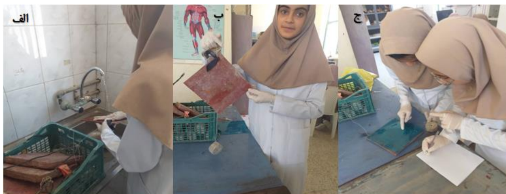
شکل 7: الف- شستن گل ولای از روی پنل ها. ب- آماده کردن پنل جهت مشاهدات. ج- اندازه گیری مساحت ناحیه بارناکل زده شده با کمک صفحه شفاف.
