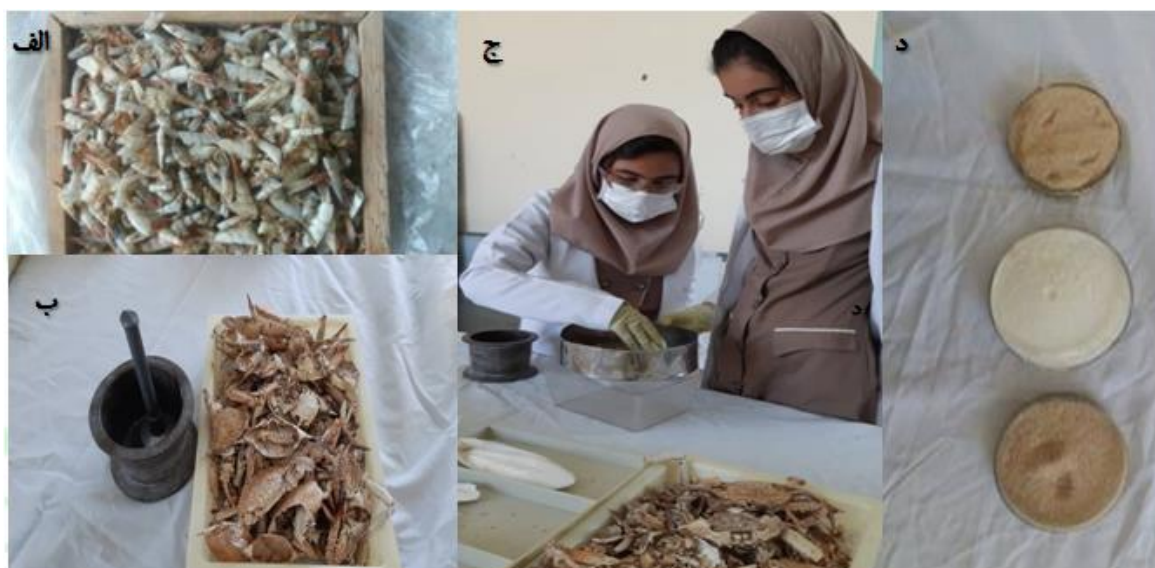
شکل 5: مراحل تولید پودر پوسته آبزیان. الف- خشک کردن پوست آبزیان در آفتاب. ب- خرد کردن به ابعاد ریز با هاون ج- الک کردن. جمع آوری پودر پوسته آبزیان (میگو، ماهی مرکب و خرچنگ) به صورت جداگانه.
